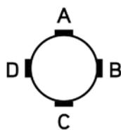
NELLE SCATOLE DELLA SERIE MULTIBOX E' NECESSARIO SPECIFICARE IL CODICE DELLE USCITE CHE SI DESIDERA SIANO APERTE (A,B,C,D) ED IL LORO DIAMETRO (16,22,28)
